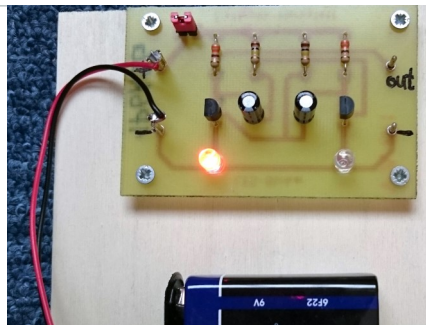
1. LED-Blinker: Die zwei Leuchtdioden blinken abwechselnd insgesamt 60 Mal in einer Minute.
